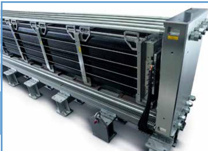
Um Energie in Wasserstoff umzuwandeln, braucht es High-Tech, wie diesen Elektrolyseur. Foto: SWW
